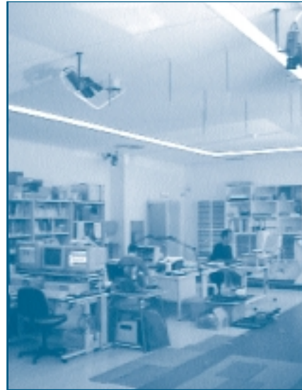
Aspecto general del laboratorio de movimientos. Cámaras del equipo KINESCAN® ancladas al techo.
