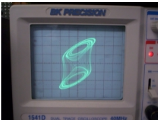
Figura 1. Oscilograma del circuito oscilador de Chua.
