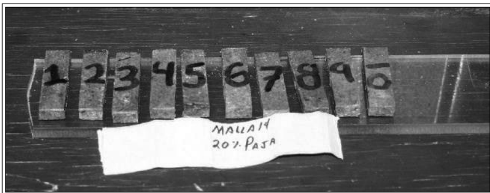
Figura 8. Probetas para las pruebas de impacto.
