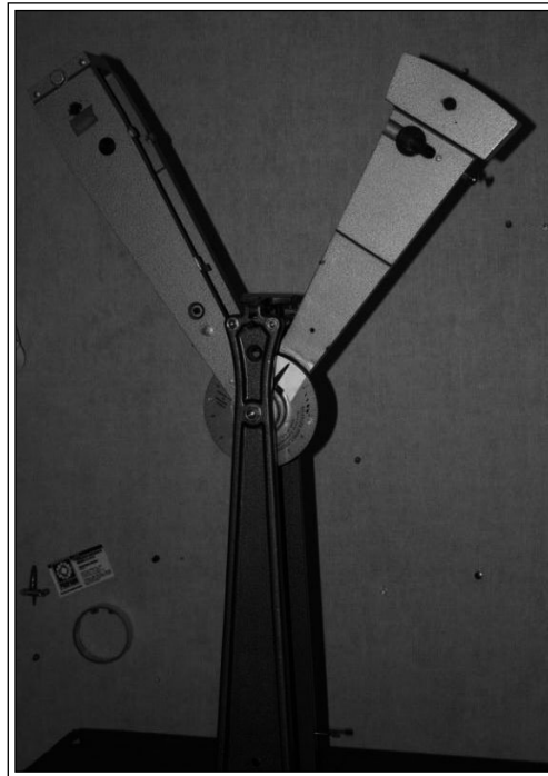
Figura 9. Máquina para realizar las pruebas de impacto.
