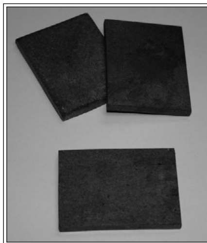
Figura 11. Placas de madera plástica con 30% de paja (malla 14, 30 y 40) y PET
