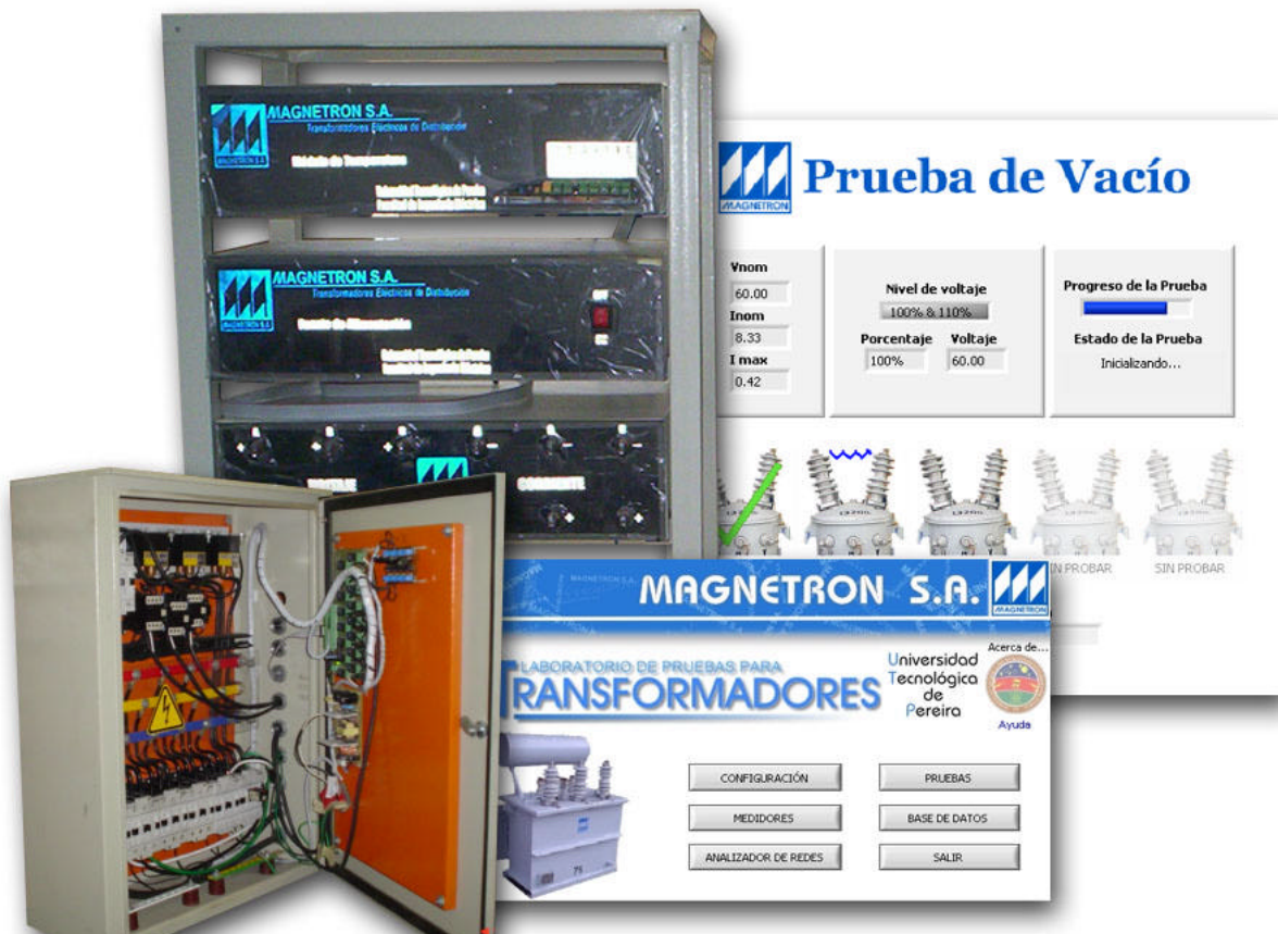
Figura 3. Nuevo sistema para la elaboración de las pruebas, se observa el módulo de adquisición de señales parte superior izquierda, el interface gráfico y el centro de conmutación de transformadores
