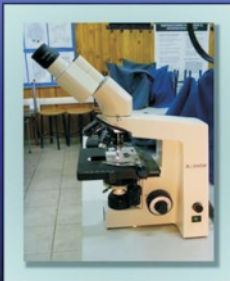
Figura 1.16. Microscopio óptico compuesto. Este microscopio posee más de un objetivo y partes mecánicas que mejoran la observación.
