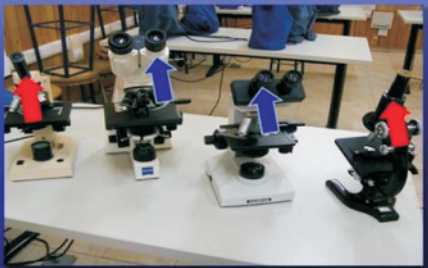
Figura 1.22. Oculares. Los oculares pueden ser binoculares (flechas azules) o monoculares (flechas rojas) dependiendo del microscopio.
