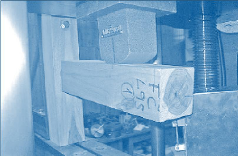
Figura 6. Ensayo de una unión
