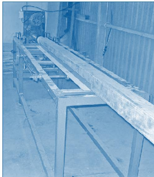
Figura 2. Vista longitudinal de máquina y sistema de sujeción de pieza de madera
