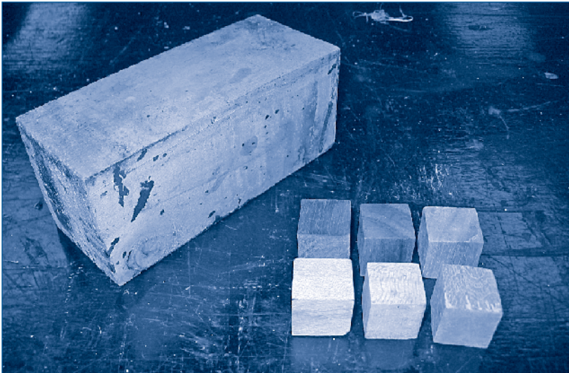
Figura 3. Probetas de madera ensayadas.
