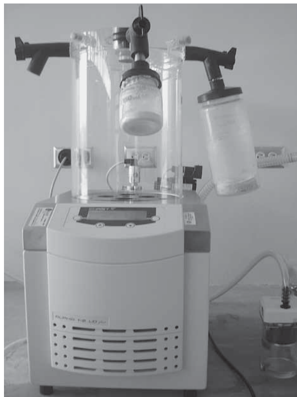
Figura 2. Para la liofilización se utilizó el Liofilizador - Freeze Dyer ALPHA 2-4 / LD.
