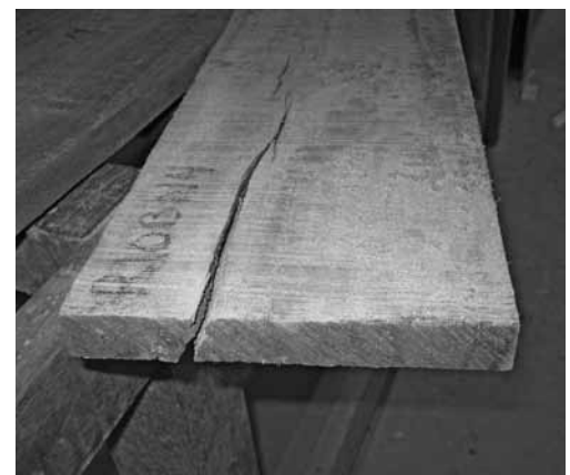
Figura 1. Reventaduras en la madera aserrada de A. mangium luego del secado convencional. (Foto: Carolina Tenorio).
