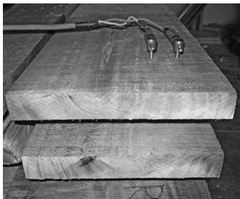
Figura 7. Colocación de la sondas de control de contenido de humedad; la tabla presenta corte radial y tangencial, perola sonda fue colocada en la parte de madera radial. (Foto: Carolina Tenorio).
