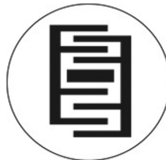
Figura 3. Monitor electroquímico de peineta de tres electrodos. Fuente: El autor.
