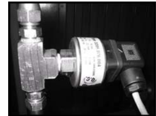
Figura 3. Sensor de presión instalado.
