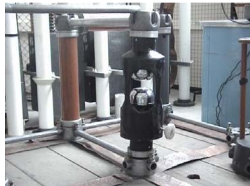
Figura 11. Aspecto final del espinterómetro.
