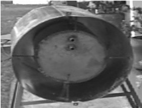
Figura 9. Fotografía del tanque y cubierta lista para el vaciado del poliuretano.
