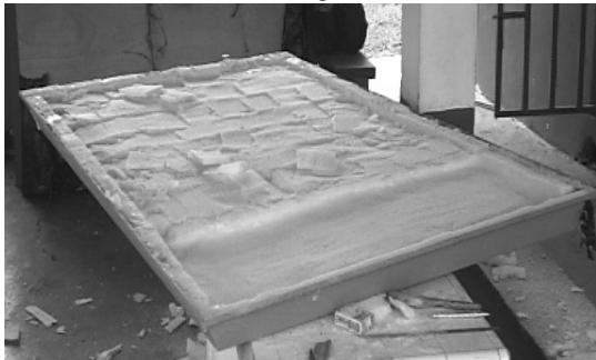
Figura 3. Proceso de tallado del aislante
