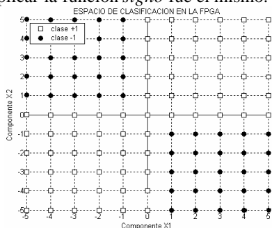
Figura 10. Espacio de clasificación obtenido por la FPGA: Espacio inicial a escala 1:1, y subespacio a escala 1:0.1
