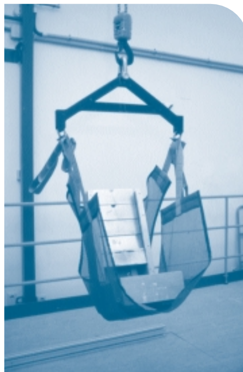
Figura 2. Resistencia estática del arnés.
