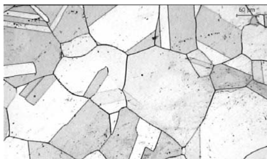
Figura 2. Microestructura del acero UNS S30403 con 0,11 % N 2 en la superficie.
