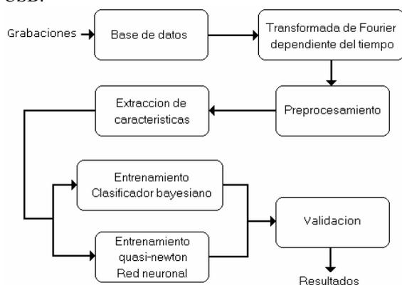
Figura 1. Diagrama del sistema implementado
