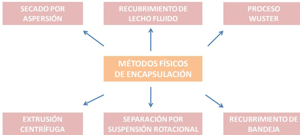
**Figura 4. Esquema de procesos físicos de encapsulación. Fuente: Elaboración propia.**
