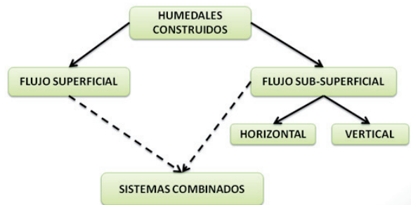
Figura 1. Clasificación de los humedales construidos.
