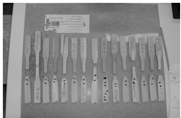
Figura 5. Probetas de Dureza Brinell ensayadas.
