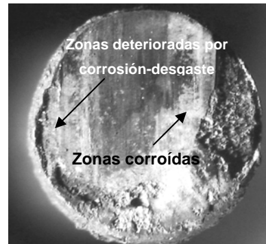
Figura 6. Superficie transversal del pin de martensita revenida, 10X.
