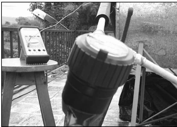
Figura 7. Fotografía ensayo de eficiencia térmica, montaje instrumentación (contador y multímetro)
