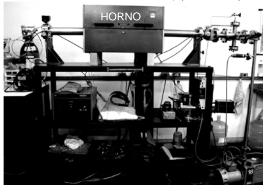
Figura 2. Equipo utilizado en la realización de los diferentes tratamientos térmicos e termoquímicos (nitruración).
