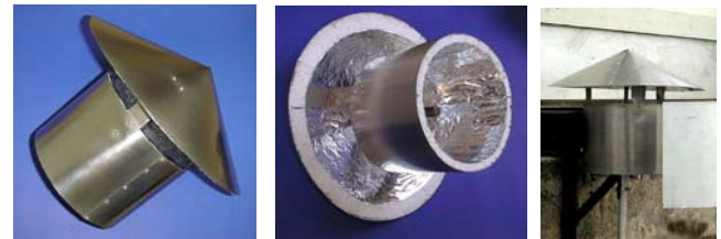
Figura 8. Sistema de medición, de la temperatura del aire exterior
