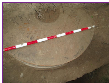
Figura7: Una de las piedras de moler de la Molina actualmente. Están fabricadas de metal. (Foto: J. López).
