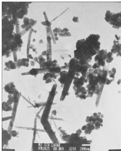
**Figura 6:** Fotografías obtenidas con MET para la muestra M2 precipitada con  $\text{NH}_4\text{OH}$  y secada en una estufa a 60 °C.
