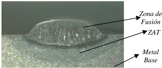
Fig. 2. Depósito de soldadura en acero CA6NM.
