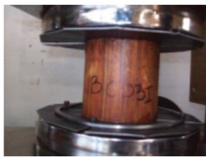
a. Probeta ensayada a carga última
