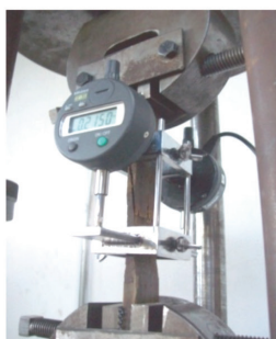
Figura 5. Ensayo de tensión paralela con determinación del módulo de elasticidad longitudinal
