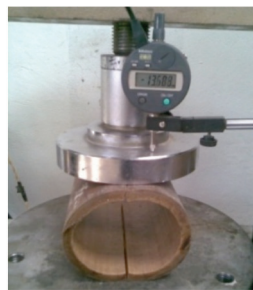
Figura 7. Esquema general ensayo compresión perpendicular
