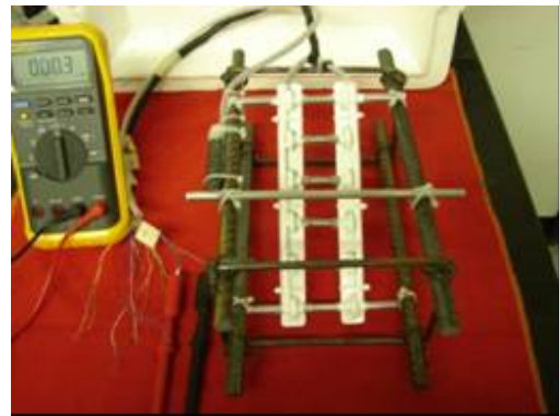
Figura 3. Revisión de la continuidad del sistema antes de ser embebido en concreto.
