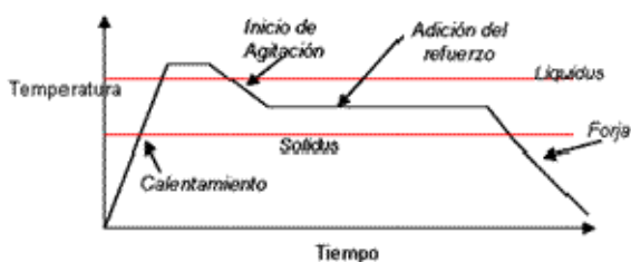
Figura 1. Método de producción de CMRPs por Compoformado
