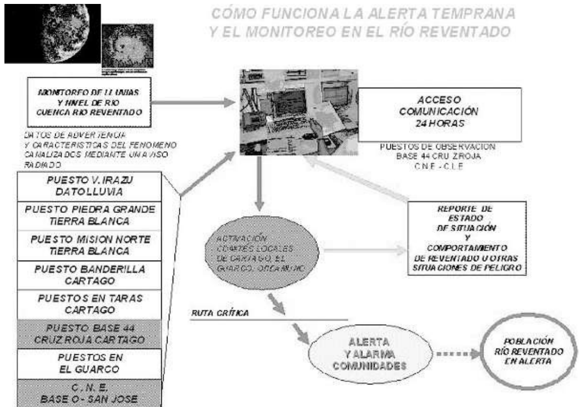
Figura 1. Esquema del sistema de alerta temprana en la cuenca del río Reventado. El sistema utiliza comunicación por radio y cuenta con participación comunitaria. Cortesía de la Comisión Nacional de Emergencias (CNE).
