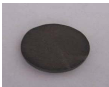
Figura 5. Foto probeta después de electrodepositar Ni
