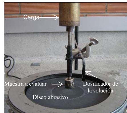
Figura 1. Montaje de la prueba de desgaste.
