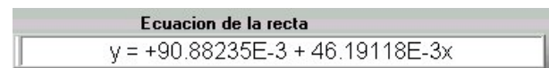
Figura 9.- Ecuación obtenida de la calibración de una cuña con nivel de precisión 5.
