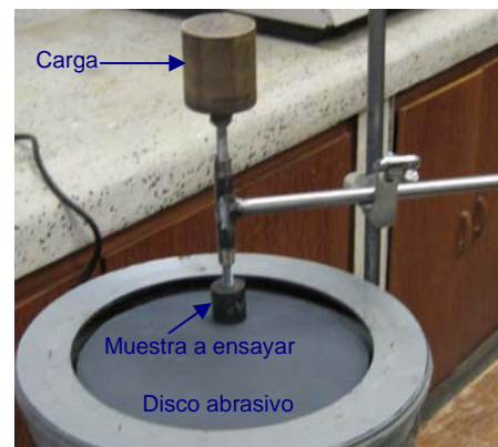
Figura 1. Montaje de la prueba de desgaste.
