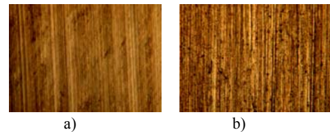
Figura 7. Muestras de cobre sometidas a desbaste en lija 600 a) Equipo diseñado y construido b) manual.
