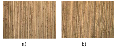
Figura 6. Muestras de cobre sometidas a desbaste en lija 400 a) Equipo diseñado y construido b) manual.
