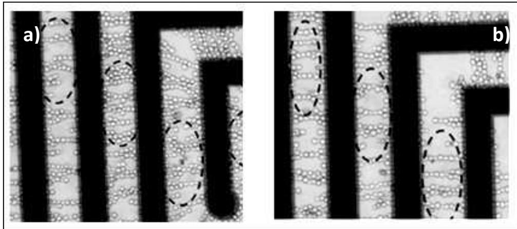
**FIGURA 9. Comparación de la concentración de levadura para un campo eléctrico aplicado a frecuencia a) 100kHz b) 1 MHz.**
