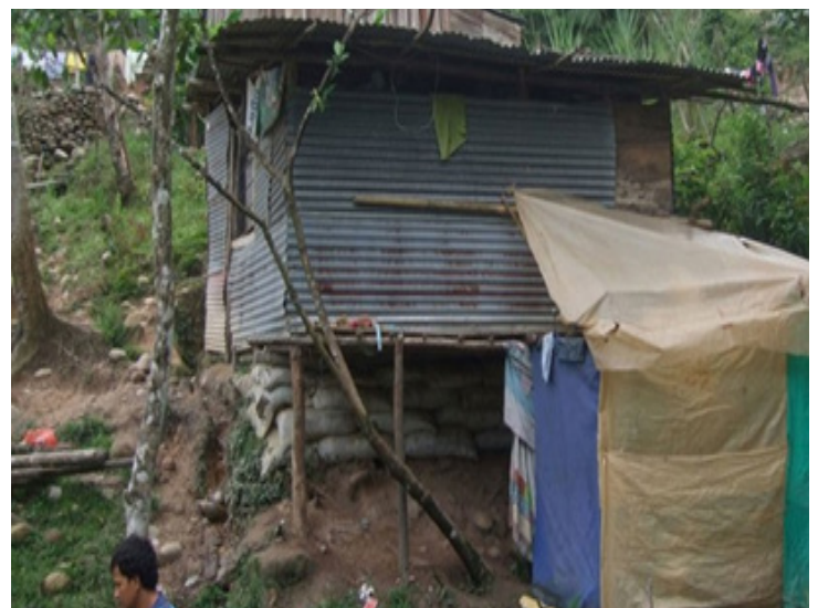
Figura 7. Aspecto del inadecuado uso y ocupación del suelo en el asentamiento de La Nohora. La fotografía indica aquí que se hace un mal manejo de las aguas residuales que se producen en las viviendas, que se asentaron sobre un terreno recientemente deslizado y que continúa desplazándose en el Presente.
