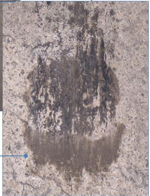
11) **FRICCION LATERAL:** Marcas que deja un neumático que rueda y que, a su vez, se desliza de costado. Su característica principal es un estriado transversal o diagonal sobre el pavimento producidas por las acanaladuras del hombro del neumático destinadas a evacuar el agua del neumático.
