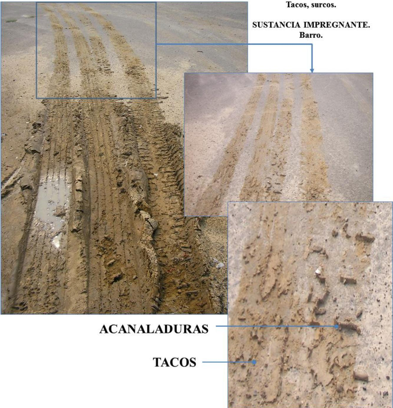
4) UNTADURA: Es la producida por el dibujo del neumático, o incluso sin apreciarse la escultura, debida al paso previo de la rueda por una sustancia liquida.
