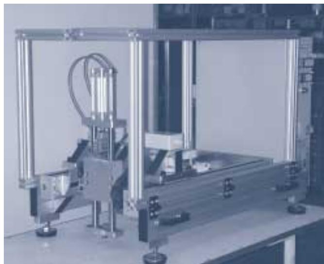
Figura 2. Prototipo de máquina de fricción.
