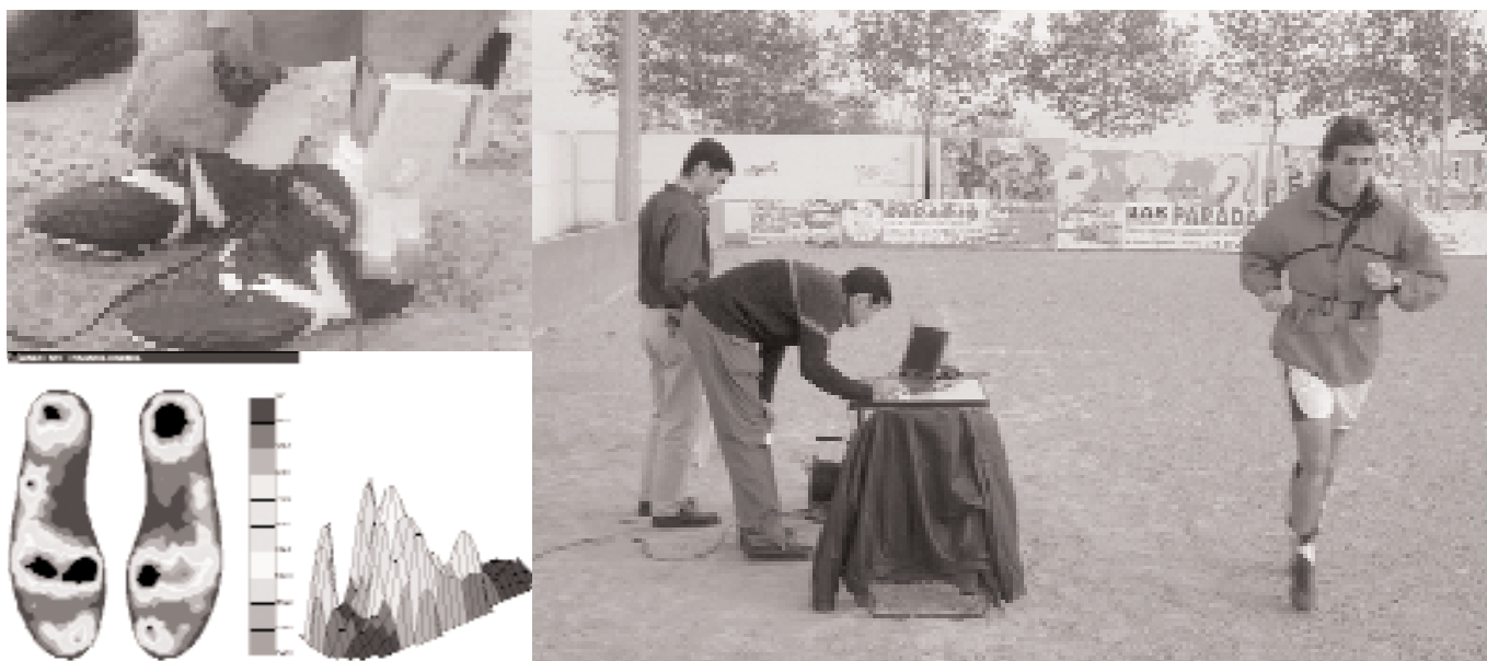
Figura 2. Ensayos de presiones plantares con sujetos.
