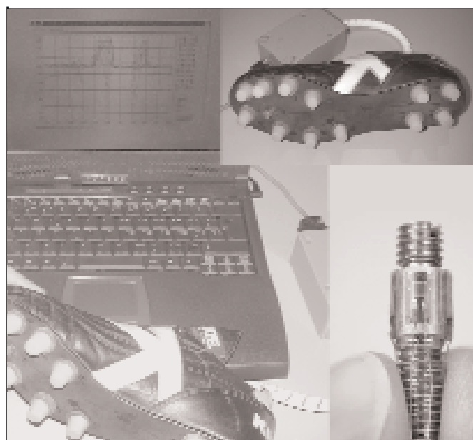
Figura 3. Equipo de medida “bota de tacos instrumentado” adaptado para realizar registros en campos de tierra.
