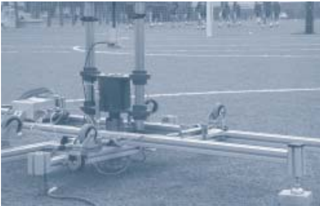
Figura 1. Ensayo de amortiguación y deformación en una instalación deportiva.
