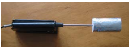
Figura 5. Pantalla de radiación para sensor de temperatura exterior.
