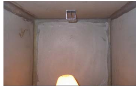
Figura 7. Pantalla de radiación para sensor de temperatura Interior.
