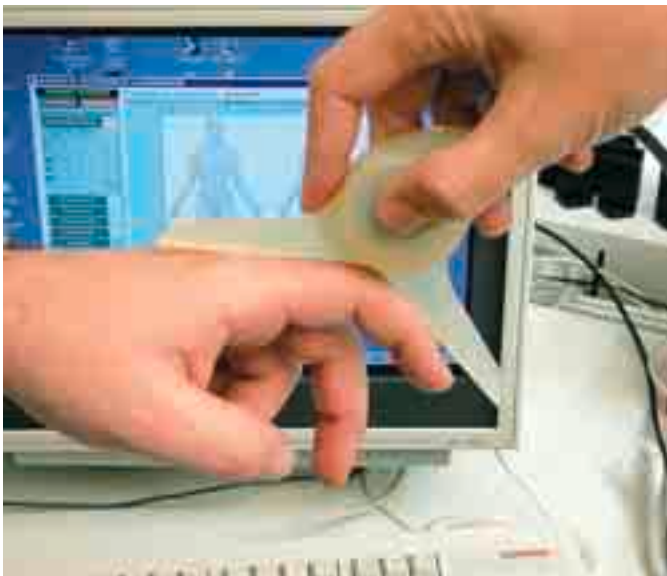
Figura 6. Prueba de uso de un prototipo del sistema de goniometría electrónica S.G.E. (desarrollo para la Sección de Aplicaciones Tecnológicas del IBV, perteneciente al conjunto de herramientas Ned/IBV).
