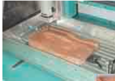
Figura 7. Desarrollo de un molde para la realización de prototipos funcionales de pisos en PU elastómero, mediante fresadora CNC.
