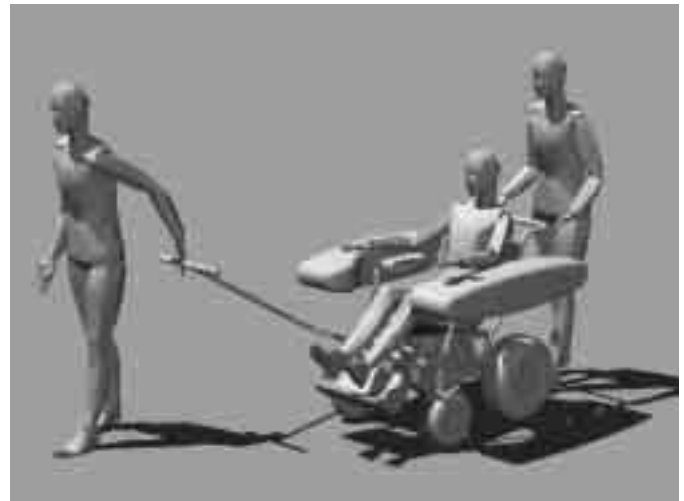
Figura 9. Prototipos virtuales y producto final de la silla anfibia MARINA para el acceso al baño y a la playa de personas con discapacidades (desarrollo promovido por la Conselleria de Benestar Social, financiado por IBERDROLA y realizado con la colaboración de la empresa VIRMEDIC).
