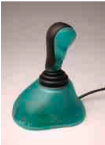
Figura 8. Pieza de preserie del dispositivo para evaluación de la coordinación motora C.M.S. realizada por colada de PU al vacío en molde de silicona (desarrollo para la Sección de Aplicaciones Tecnológicas del IBV, perteneciente al conjunto de herramientas Ned/IBV).
