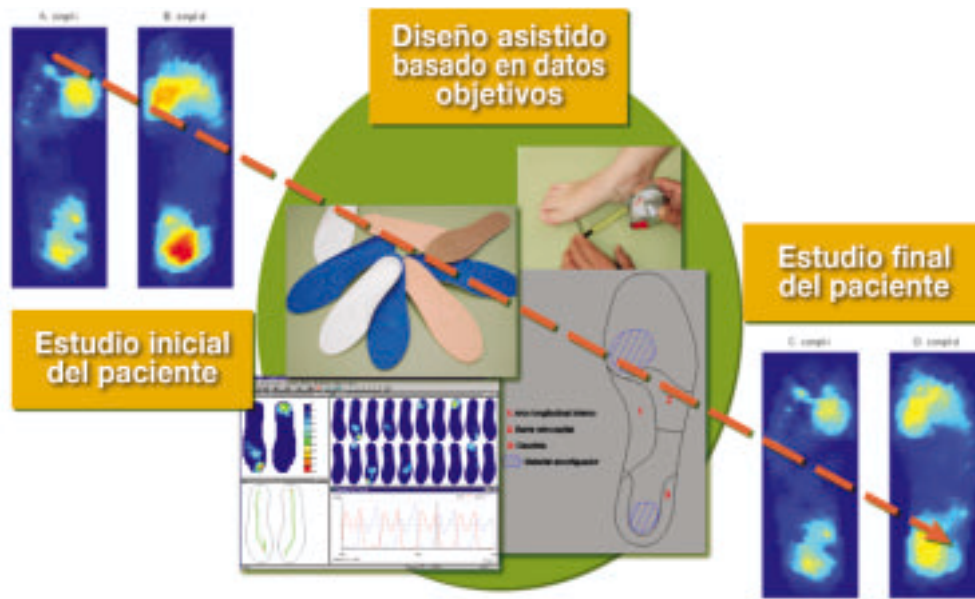
Figura 3. Procedimiento de trabajo adaptado al sector ortopédico: partiendo de un estudio inicial se realiza un diseño de la ortesis asentado en los datos objetivos proporcionados por el sistema de registro presurométrico. Tras la fabricación de la ortesis, se evalúan los resultados alcanzados de nuevo utilizando el sistema de registro.
