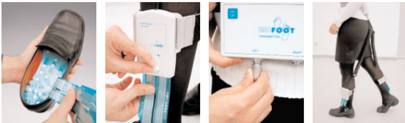
Figura 6. Secuencia de operaciones para la colocación de la plantilla (curso de iniciación al manejo del sistema de plantillas...).
