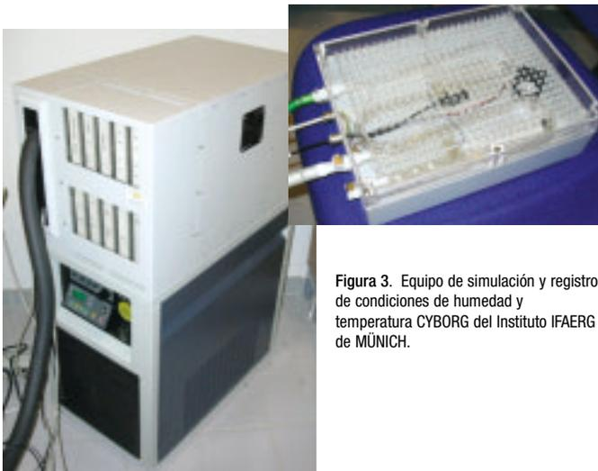
Figura 3. Equipo de simulación y registro de condiciones de humedad y temperatura CYBORG del Instituto IFAERG de MÚNICH.
