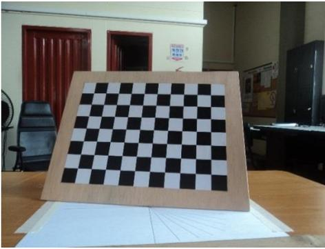
Figura 4: Patrón de calibración de Zhang Diseñado
