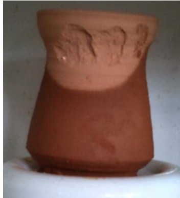
Figura 4. Pieza sometida a 200W por 5 minutos, se aprecia el secado irregular y las fracturas superficiales a partir de burbujas.
