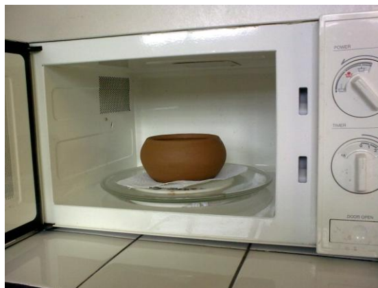
Figura 2. Pieza de cerámica durante el proceso de secado en un horno doméstico de microondas.
