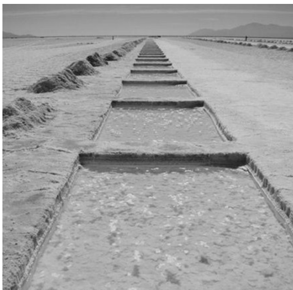
Figura 8. Vista de un salar en La Pampa donde se observan las piletas que permiten la extracción del cloruro de sodio. Foto archivo personal.
