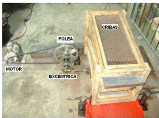
Figura 5. Prototipo de máquina prelimpiadora de arroz paddy construido.
